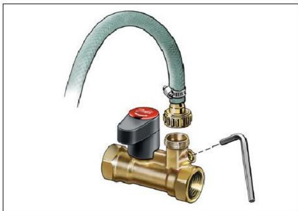
Клапан оснащен дренажным краном, открыть который можно с помощью 6-мм шестигранного ключа, отвернув стопорный винт.
