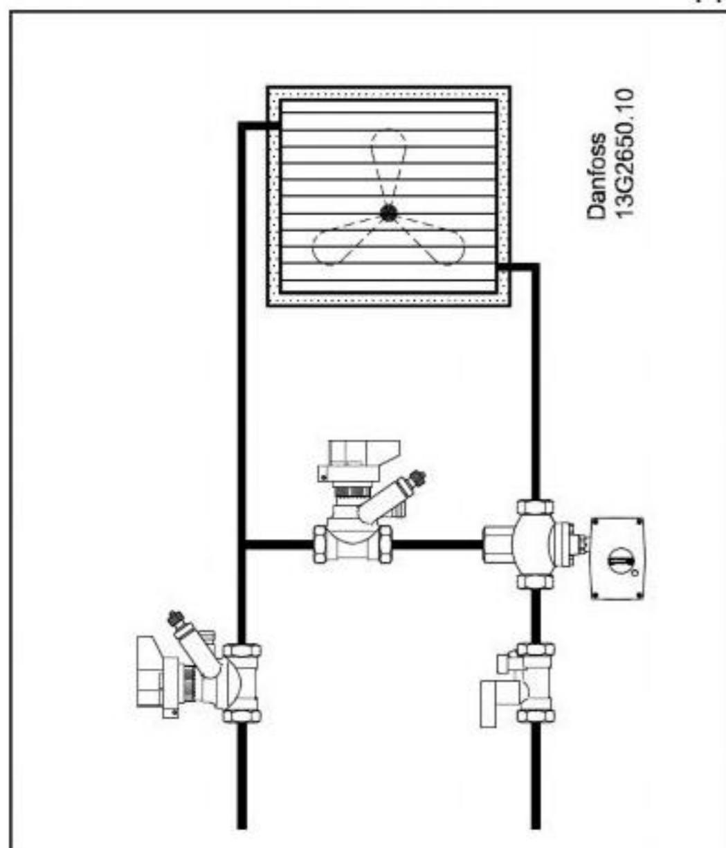
В обвязках вентиляционных установок, центральных кондиционеров, фэнкойлов.
