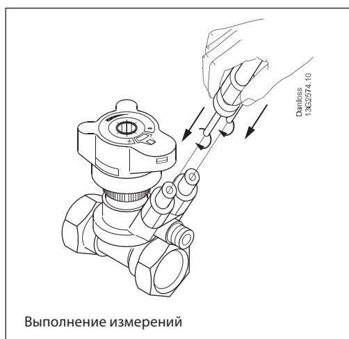
Расход через клапан Leno™ MVT можно проверить с помощью измерительных приборов Danfoss PFM 5001 или других производителей.
