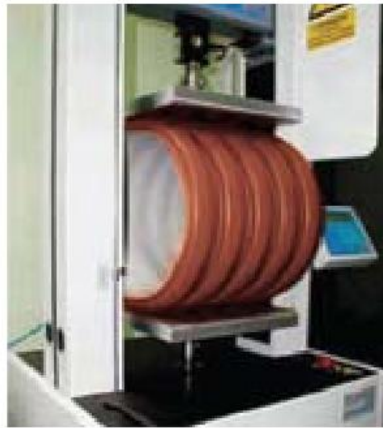
РИСУНОК 1. Кольцевая жесткость. Испытания в соответствии с EN ISO 9969
