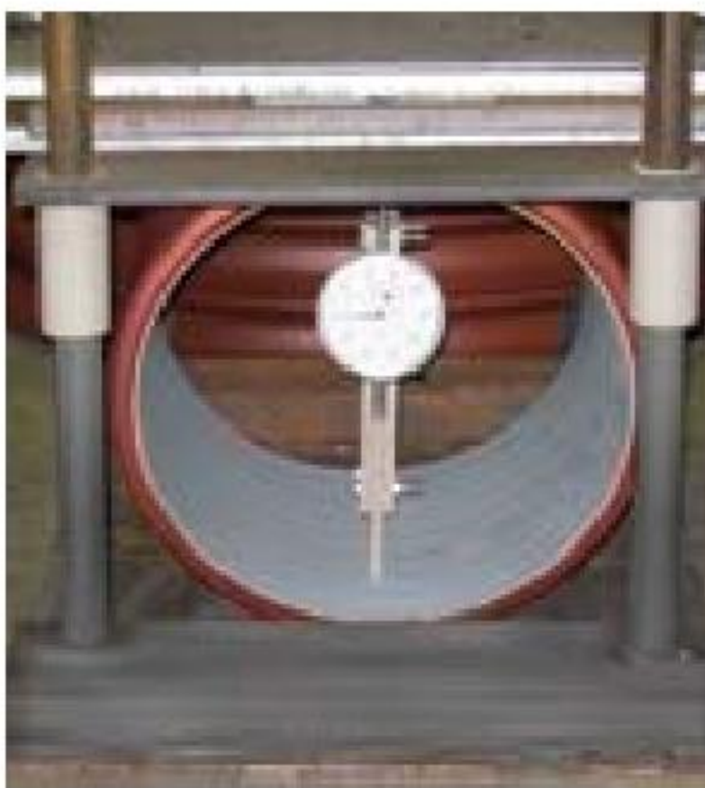
РИСУНОК 3. Коэффициент ползучести материала (Creep ratio) в соответствии с EN ISO 9967
