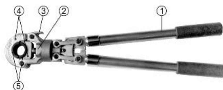
Усилие, прикладываемое к рукояткам инструмента (1), с помощью зубчатого механизма передается на выдвижной шток пресс - головки (2), который, сближая две полуобоймы, воздействует на закрепленные в них пресс - вкладыши.
