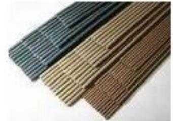
Сварка электродами **МР-3С** (синие) производится во всех положениях в пространстве, включая вертикальное сверху вниз, на переменном токе и постоянном токе обратной полярности от источников питания с напряжением холостого хода от 50 Вольт.
