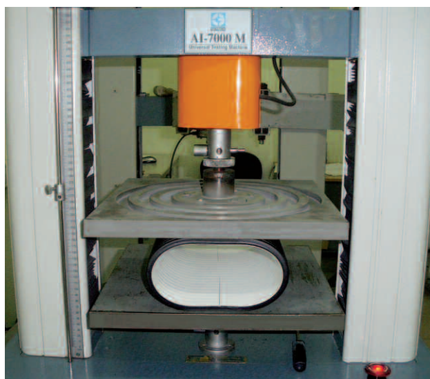
Рис. 5. Испытания на кольцевую жесткость
