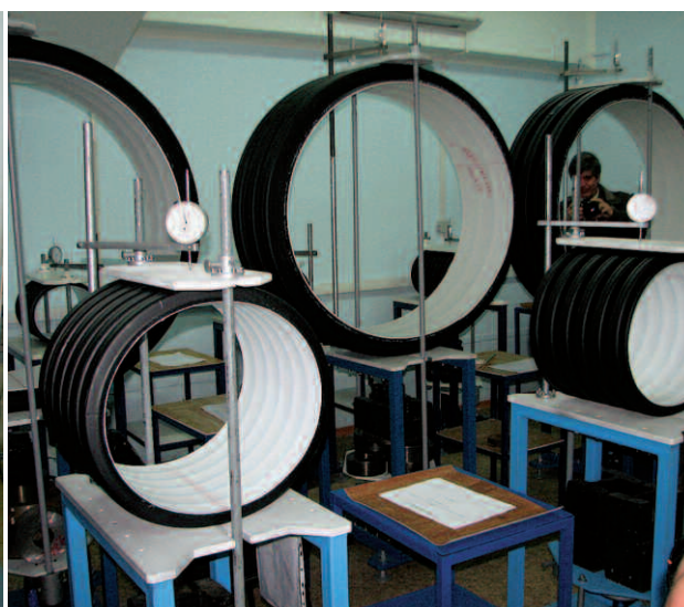
Рис. 6. Испытания на кольцевую гибкость
