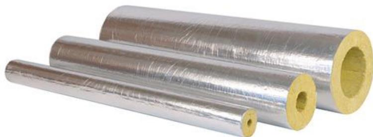
2. Цилиндры кашированные армированной алюминиевой фольгой (алюминиевая фольга в данном случае выполняет функцию пароизоляции и эстетическую функцию в случае, когда изолируемый объект находится в помещении, и нет необходимости в дополнительной защите от механических воздействий и воздействий окружающей среды).
