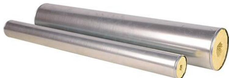
3. Цилиндры с покрытием METAL (представляют собой теплоизоляционную конструкцию с покровным слоем из оцинкованной стали толщиной 0,55 мм, рекомендованы к применению на открытом воздухе для защиты от значительных механических воздействий. Возможно изготовление покровного слоя из алюминия или нержавеющей стали).
