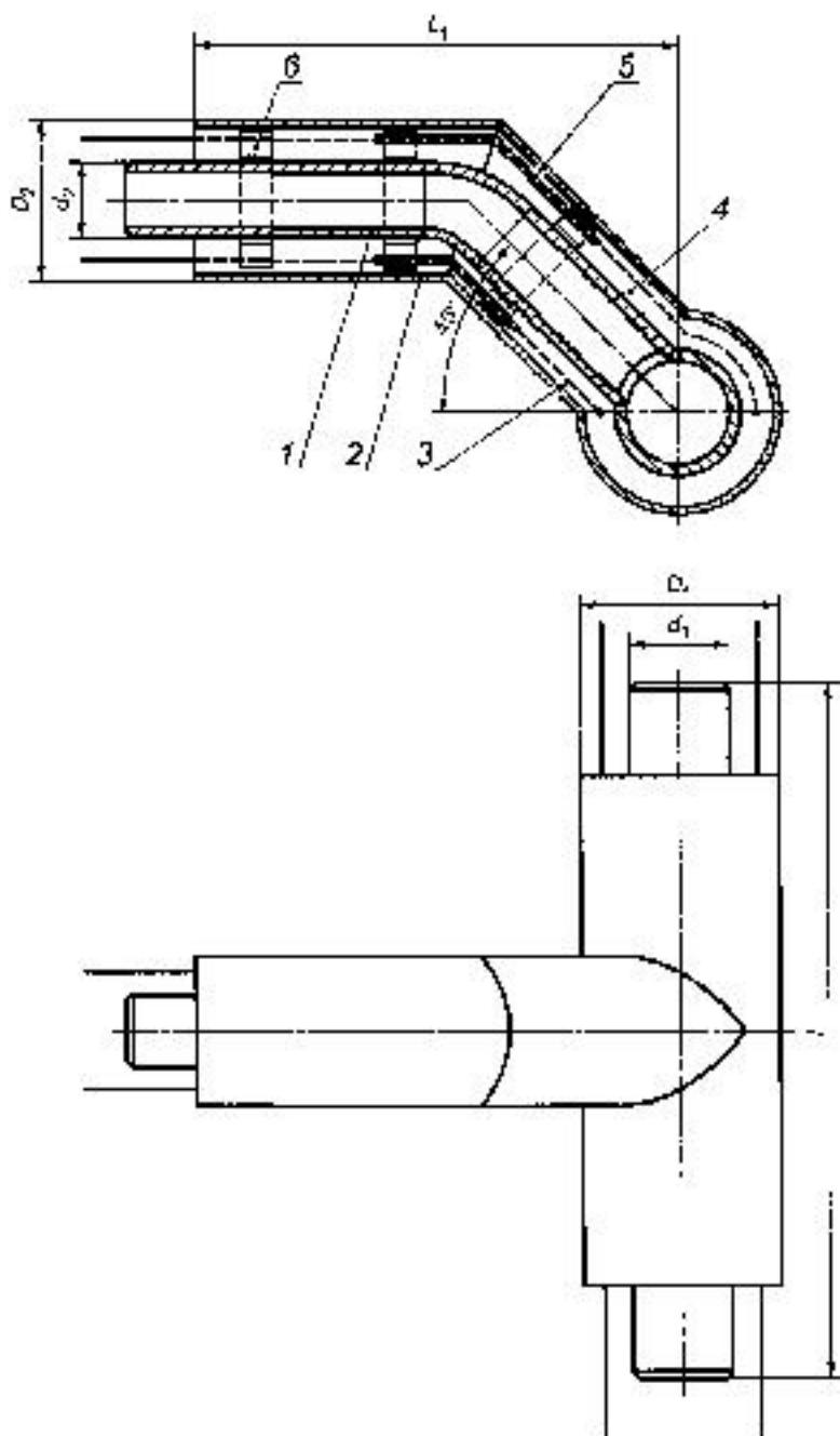
1 — стальной отвод; 2 — оболочка; 3 — проводник—индикатор системы ОДК; 4 — изоляция из пенополиуретана; 5 — электроизоляционная трубка (для труб со стальной оболочкой);
