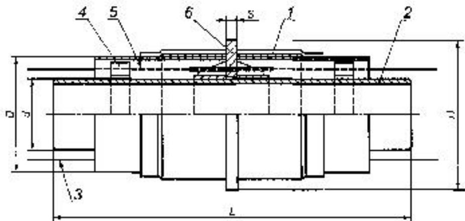
1 — ПЭ-оболочка; 2 — стальная труба; 3 — проводник—индикатор СОДК; 4 — центрирующая опора;
