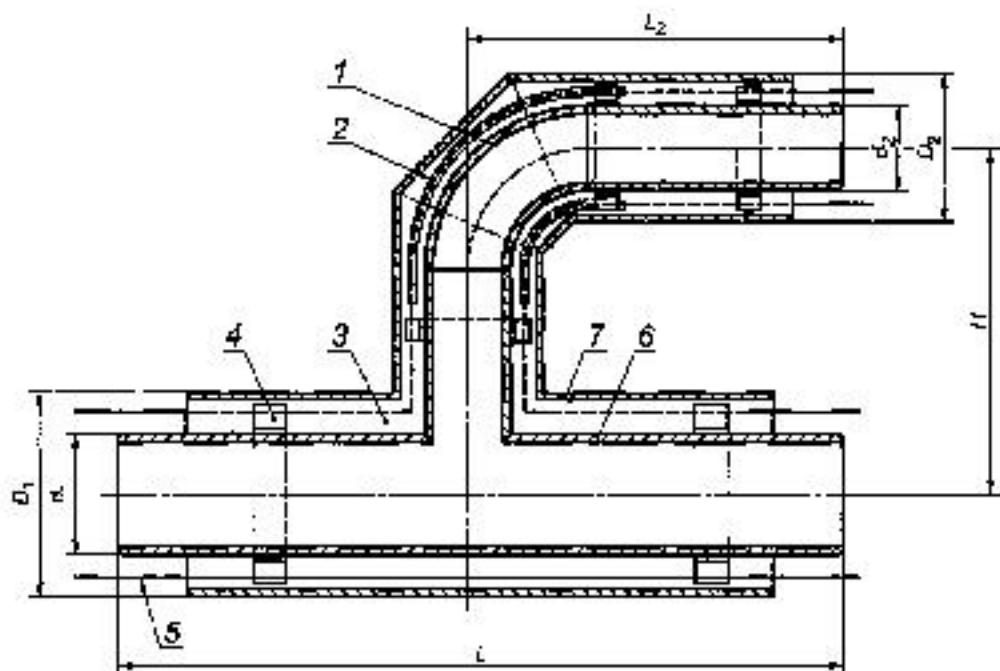
1 — стальной отвод; 2 — электроизоляционная трубка (для труб со стальной оболочкой); 3 — изоляция из ППУ; 4 — центрирующая опора; 5 — проводник—индикатор системы ОДК; 6 — стальная труба;
