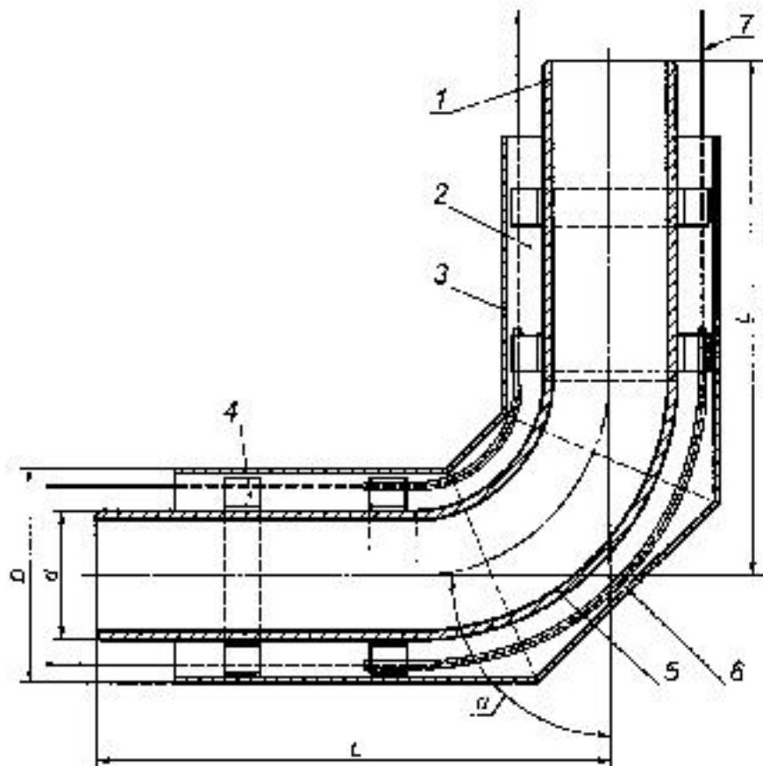
1 — стальная труба; 2 — изоляция из ППУ; 3 — оболочка; 4 — центрирующая опора; 5 — стальной отвод; 6 — электроизоляционная трубка (для труб со стальной оболочкой);
