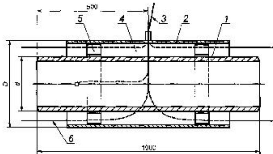
1 — стальная труба; 2 — оболочка; 3 — кабельный вывод; 4 — изоляция из ППУ;
