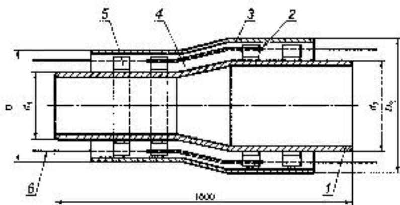
1 — стальная труба; 2 — электроизоляционная трубка (для труб со стальной оболочкой); 3 — оболочка;
