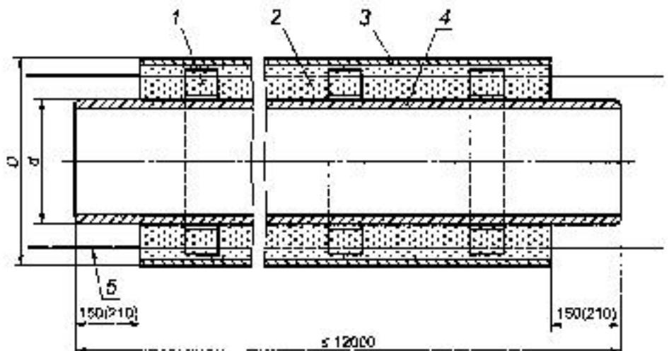
1 — центрирующая опора; 2 — изоляция из ППУ; 3 — труба-оболочка; 4 — стальная труба;
