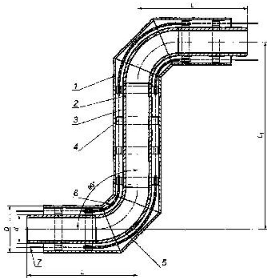
1 — оболочка; 2 — стальная труба; 3 — изоляция из ППУ; 4 — центрирующая опора; 5 — стальной отвод; 6 — электроизоляционная трубка (для труб со стальной оболочкой);
