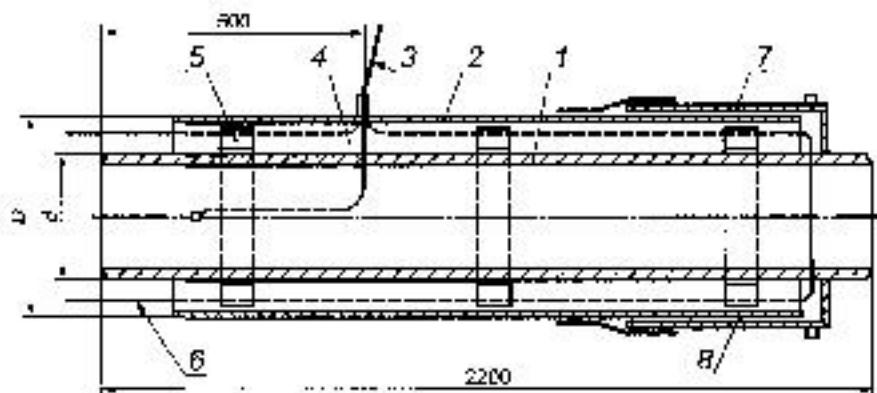
1 — стальная труба; 2 — оболочка; 3 — кабельный вывод; 4 — изоляция из ППУ; 5 — центрирующая опора; 6 — проводник—индикатор СОДК; 7 — металлическая заглушка изоляции; 8 — герметик (термоусадочное полотно)
