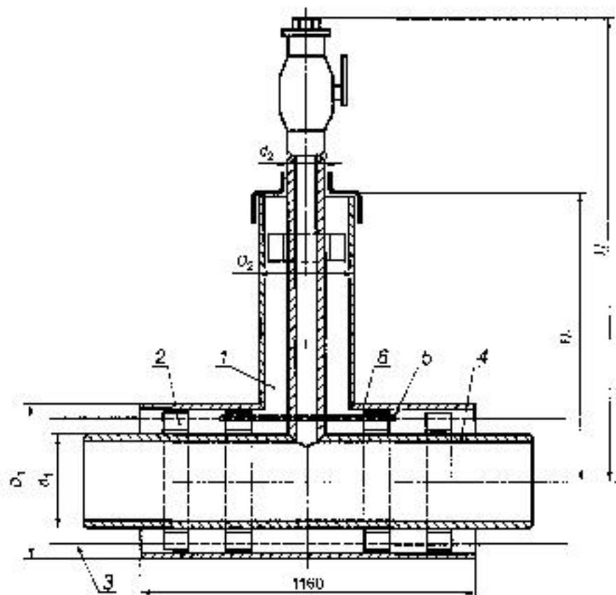
1 — изоляция из ППУ; 2 — центрирующая опора; 3 — проводник—индикатор СОДК; 4 — стальная труба; 5 — электроизоляционная трубка (для труб со стальной оболочкой);
