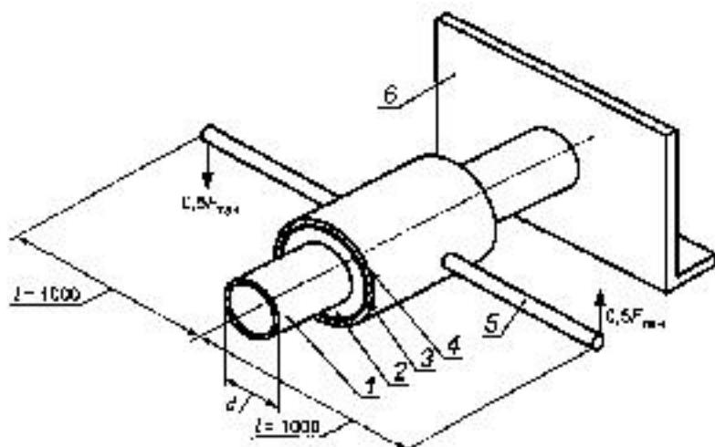
1 — стальная труба; 2 — изоляция из ППУ; 3 — труба-оболочка из полистиленов; 4 — хомут; 5 — рычаг; 6 — неподвижная опора
