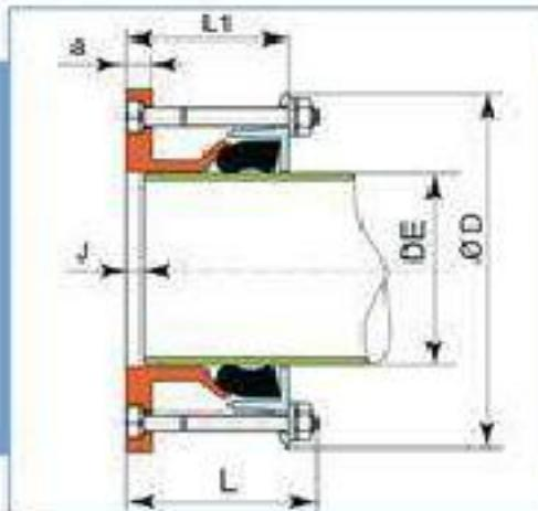
Фланцевые адаптеры (ПФРК) UltraQuick PN10/16 для труб из разных материалов, с широким диапазоном наружных диаметров.
