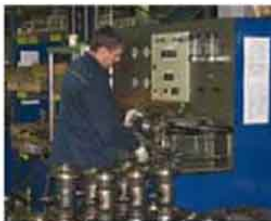
Тестирование шаровых кранов
