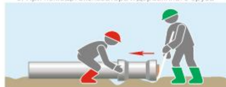
4. При помощи лома и деревянного бруса
