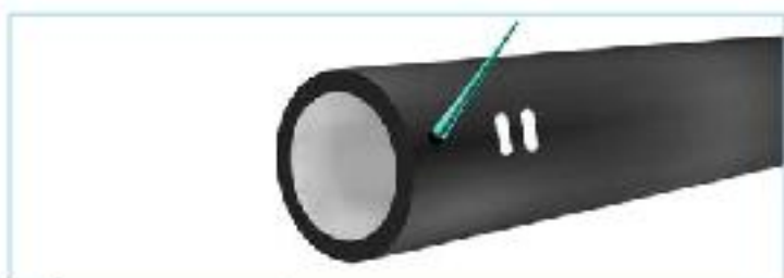
3. Смазка наружной поверхности гладкого конца трубы
