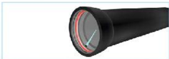
6. Смазка внутренней поверхности уплотнительного кольца
