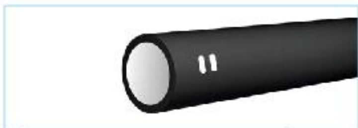
2. Специальная метка на гладком конце трубы
